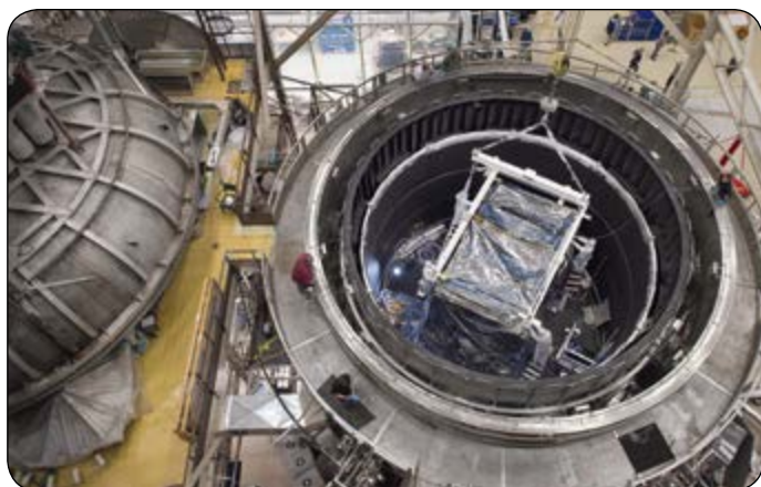
For fire måneder siden blev instrumenterne til rumteleskopet James Webb forsigtigt sænket ned i vakuumsfryser, der efterfølgende blev lukket, udpumpet og nedkølet. (Foto: Nasa/Chris Gunn)
